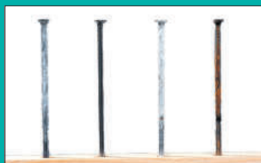
Próbki gwoździ po 24 godzinach (1cykl) w komorze wilgotnościowej
