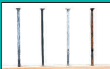
Próbki gwoździ po 96 godzinach (4 cykle) w komorze wilgotnościowej
